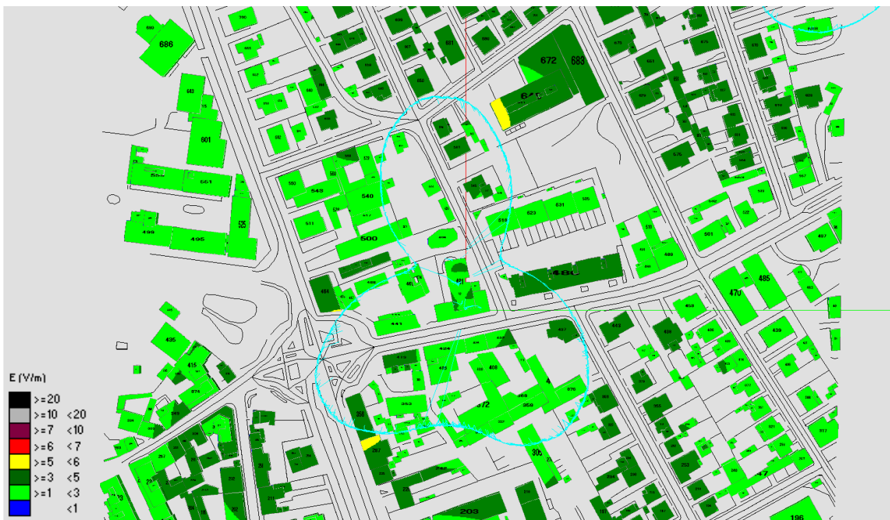
Fig. 128 Impatto elettromagnetico - Zona Via Duino - Vista dall'alto
