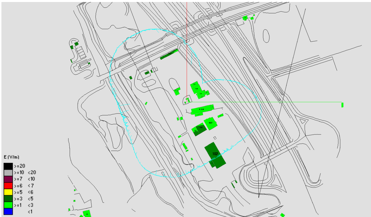
Fig. 312 Impatto elettromagnetico - Zona Via Basiliano - Vista dall'alto
