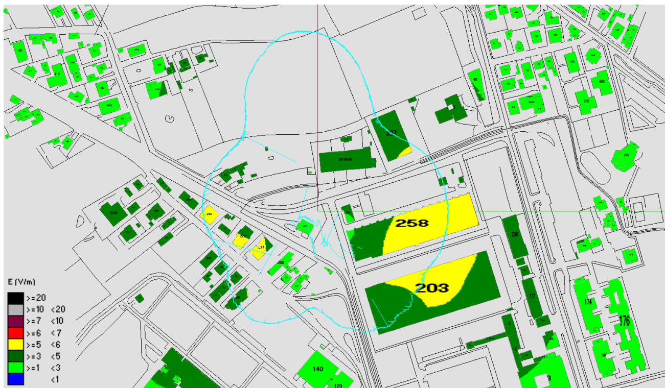
Fig. 63 Impatto elettromagnetico - Zona Via Sondrio - Vista dall'alto
