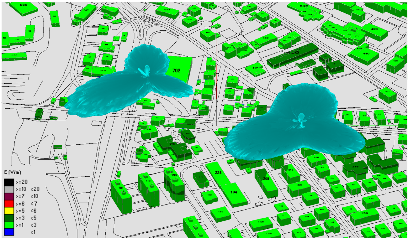
Fig. 77 Impatto elettromagnetico - Zona Viale dello Sport - 0°/Nord
