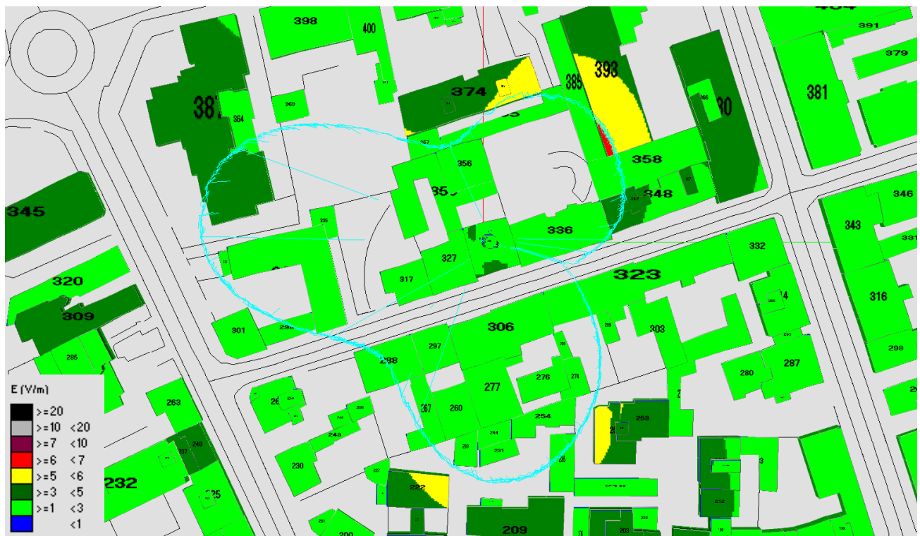
Fig. 217 Impatto elettromagnetico - Zona Via Ippolito Nievo - Vista dall'alto
