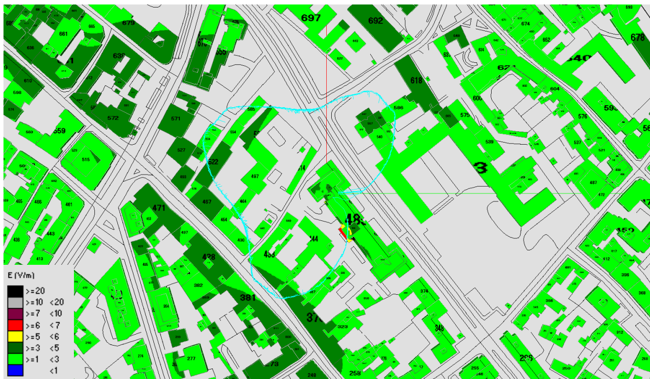
Fig. 163 Impatto elettromagnetico - Zona Viale Ungheria - Vista dall'alto
