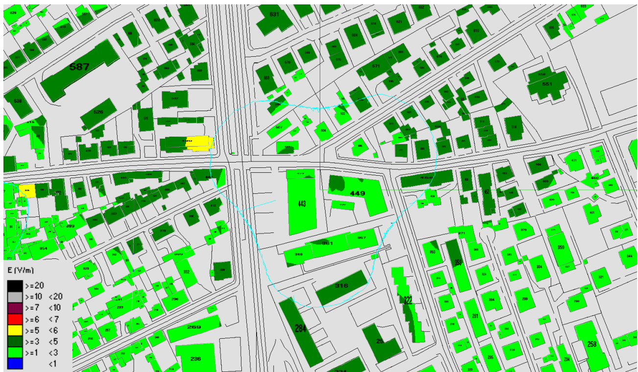
Fig. 153 Impatto elettromagnetico - Zona Via del Bon - Vista dall'alto
