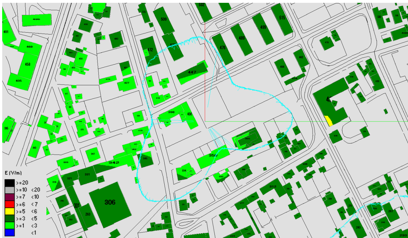
Fig. 322 Impatto elettromagnetico - Zona Via Pozzuolo - Via Tre Novembre - Vista dall'alto
