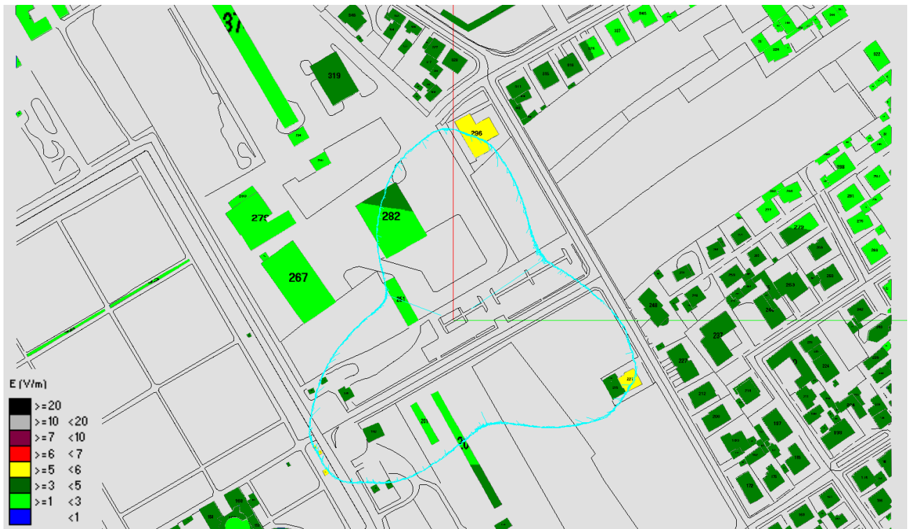
Fig. 287 Impatto elettromagnetico - Zona Via Luzzato - Vista dall'alto
