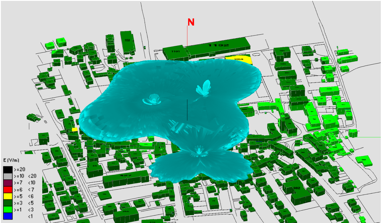
Fig. 37 Impatto elettromagnetico - Zona Via Piemonte - 0°/Nord
