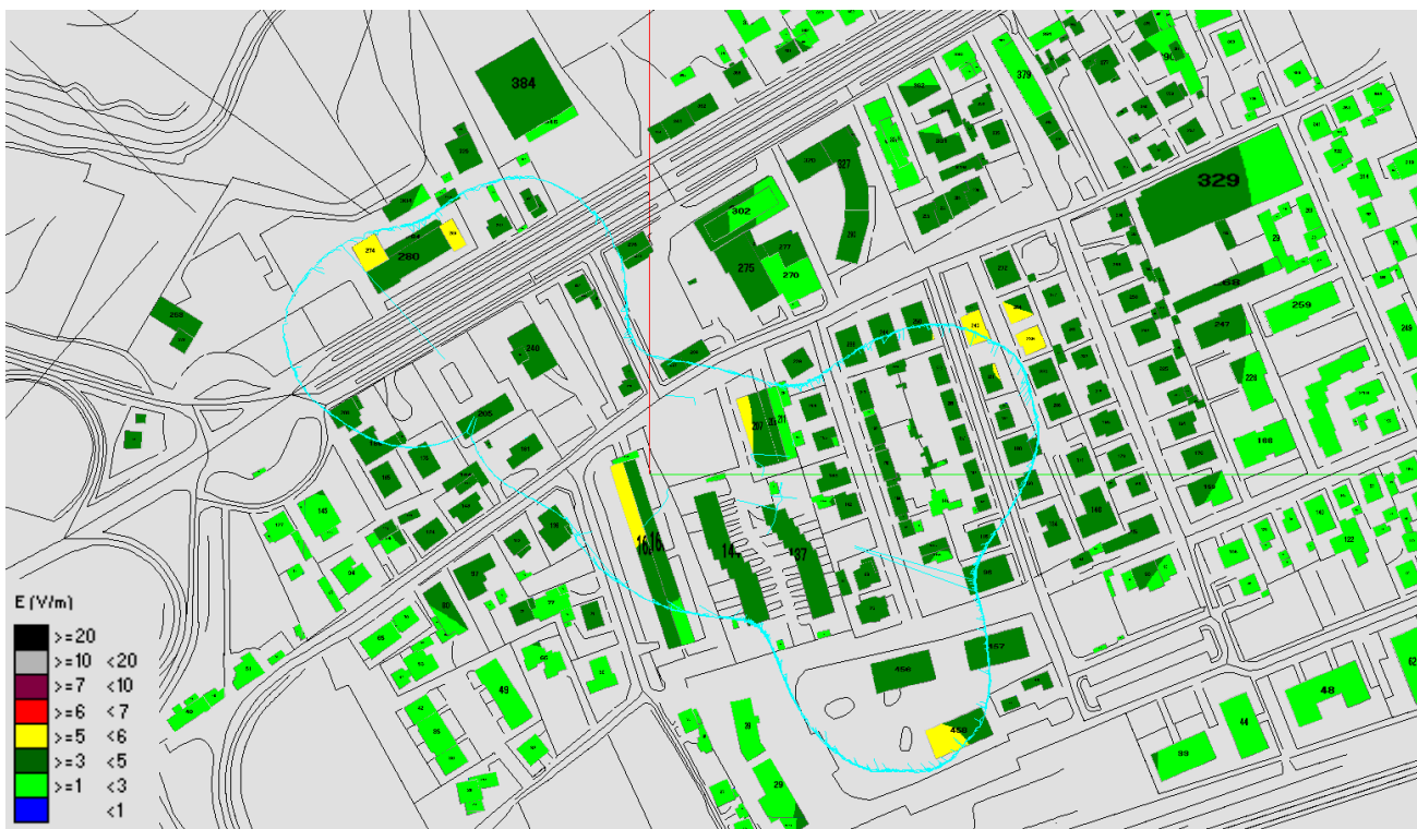
Fig. 302 Impatto elettromagnetico - Zona Viale Venezia - Via Pertoldo - Vista dall'alto
