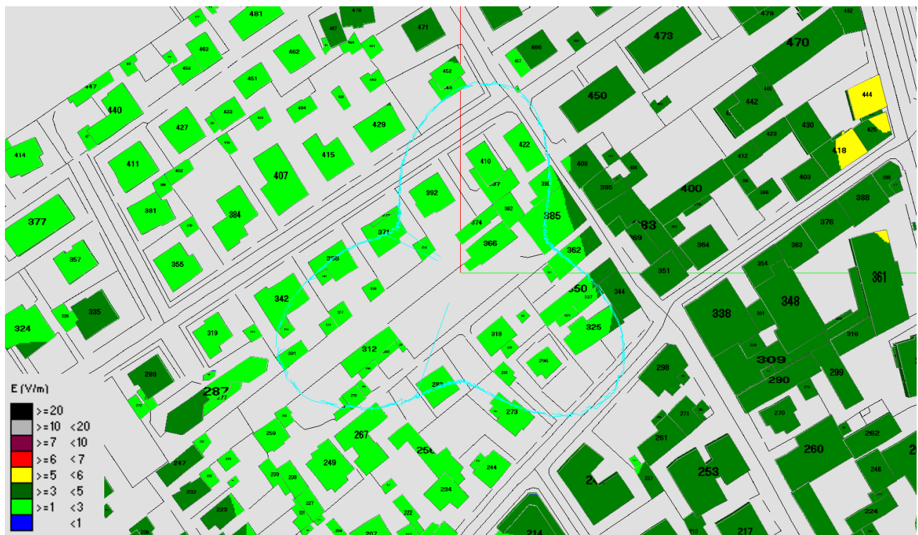
Fig. 198 Impatto elettromagnetico - Zona Via Bezzecca - Vista dall'alto
