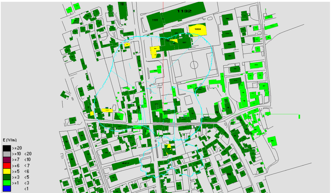
Fig. 38 Impatto elettromagnetico - Zona Via Piemonte - Vista dall'alto
