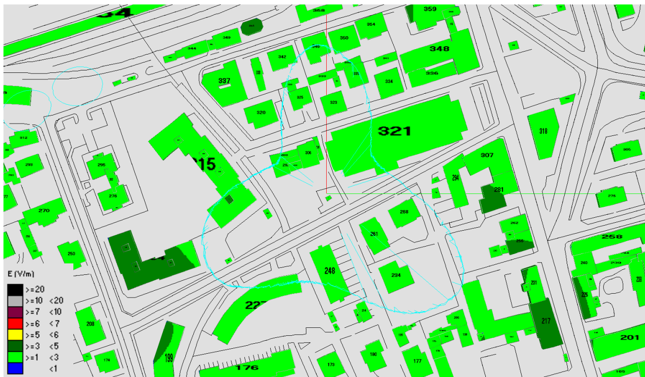
Fig. 237 Impatto elettromagnetico - Zona Via Medici - Vista dall'alto
