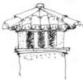
Materiale: le cornici del comignolo sono realizzate in due strati sovrapposti di piastrelle di cotto, a vista. Se realizzate in muratura intonacata devono rispettare le stesse dimensioni (limitate) in altezza. I sostegni del cappello sono realizzati in muratura intonacata agli angoli e in piastrelle di cotto, a vista, nelle parti centrali.
