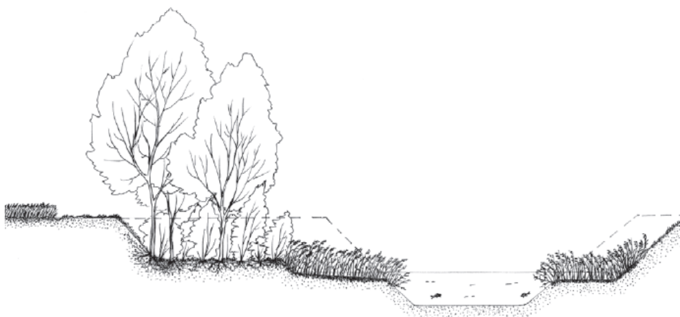
Figura 15: schema di ampliamento della sezione idraulica di un canale.
