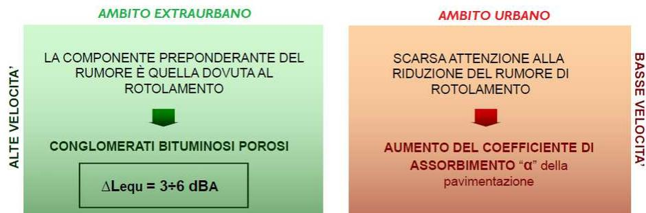
Figura 5-1. Riduzione del rumore tramite l'utilizzo di pavimentazioni antirumore
