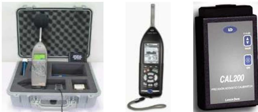
Figura 2-18. Da sx: fonometro LD824, fonometro LD831, calibratore CAL200
