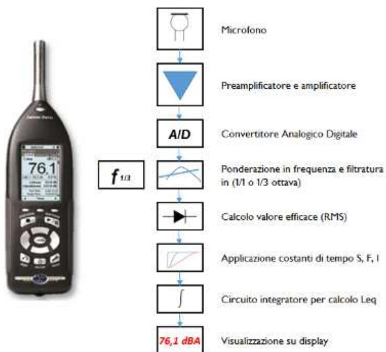
Figura 2-1. Schema a blocchi di funzionamento di un fonometro integratore
