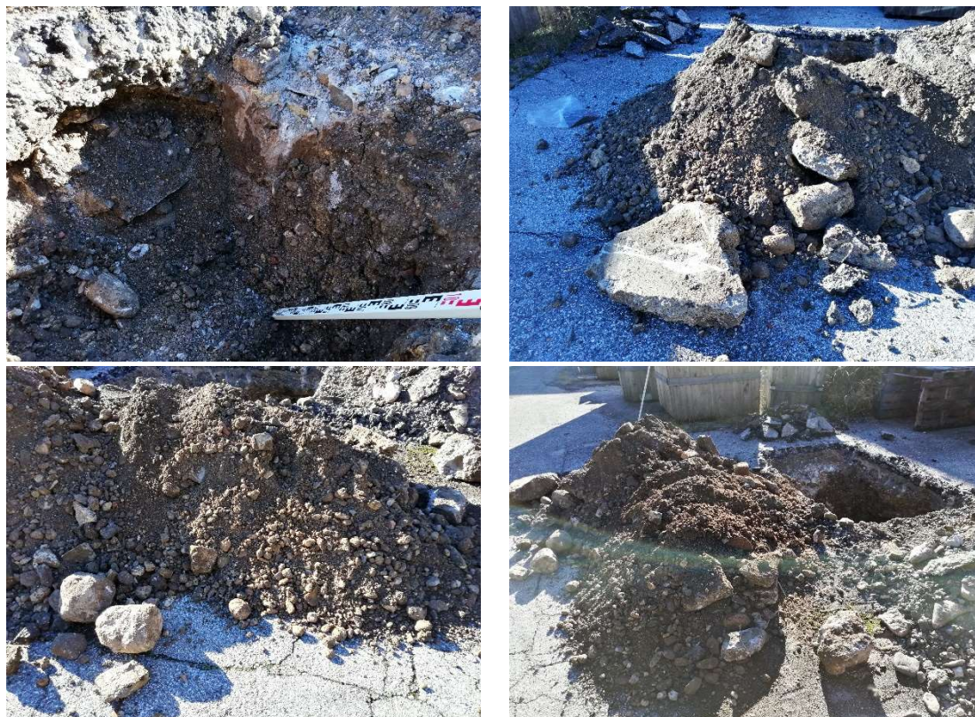
Figura 3.2 – Terreno di riporto con materiale antropico [foto: Multiproject]
